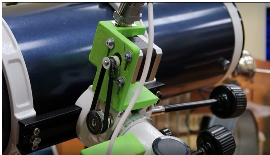
Рис. 6. Крепления приводов: слева — по склонению, справа — по прямому восхождению
