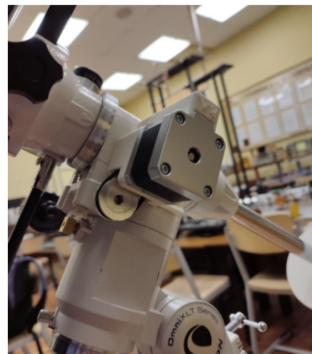
Рис. 6. Крепления приводов: слева — по склонению, справа — по прямому восхождению
